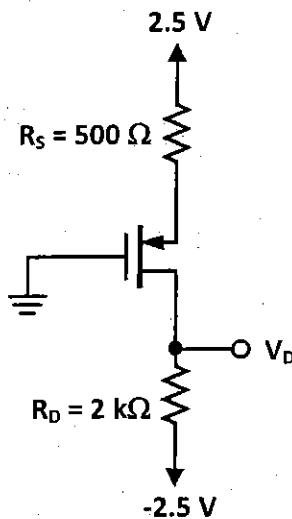
8. 如下圖所示電路，MOS 電晶體的等效電路如圖所示於旁，其  $g_m = 1.6 \text{ mA/V}$ ,  $g_{mb} = 0.2 \text{ mA/V}$ ,  $r_o = 5 \text{ k}\Omega$ 。請算出此用固定電流源偏壓的共汲極(common drain)電路之電壓增益  $V_o/V_i$ 。
