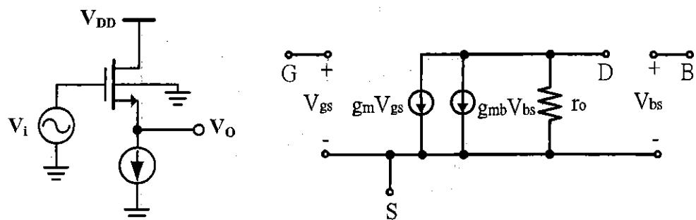
9. 已知下圖電晶體偏壓於主動區 (Saturation)，且  $g_m$  值為  $1 \text{ mA/V}$ 。假設電晶體本身之寄生電容以及 channel length modulation ( $\lambda = 0$ ) 皆可忽略。試問下圖放大器於遠低於  $-3 \text{ dB}$  頻寬以下量測之  $C_{in}$  為何？
