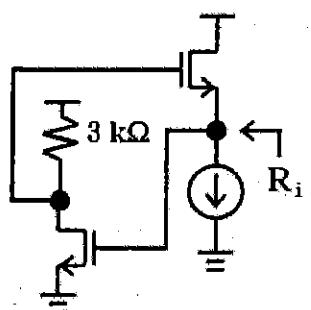
20. 分析下圖之電路。假設所有 MOS 皆工作於飽和區且忽略 body effect 與 channel-length modulation ( $\lambda = 0$ )。若所有 MOS 之  $g_m = 1 \text{ mA/V}$ ，試求輸出電阻  $R_o$ 。
