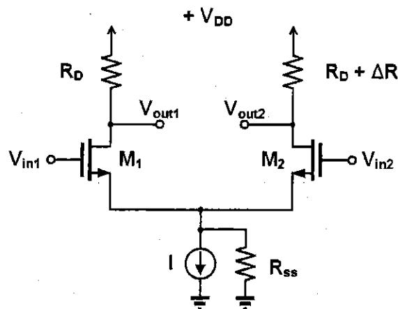
17. 下圖為 MOS 差動放大器。 $V_{DD} = V_{SS} = 2.5$  V、 $R_D = 5$  kΩ、 $I = 0.2$  mA。圖中電晶體之  $\mu_n C_{ox}(W/L) = 3$  mA/V<sup>2</sup>、 $V_{TH} = 0.7$  V。忽略通道效應、基底效應。電流源 I 最少需要跨壓 0.3 V 以維持正常運作。求  $V_{CM}$  能使差動放大器維持在飽和區，並使電流源正常運作的最大值。(答案四捨五入取三位有效數字，單位 Volts)
