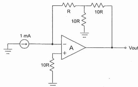
3. 分析以下電路，假設圖中運算放大器(operational amplifier)為理想。求輸出電壓  $V_{out}$  (V)。
