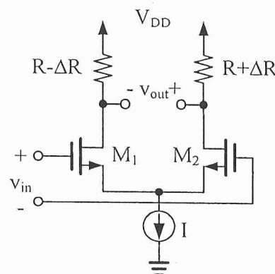
19. 分析下圖之電路，假設所有 MOS 電晶體皆工作於飽和區且忽略 body effect 與 channel-length modulation effect。假設所有 NMOS 之  $g_m = 1 \text{ mA/V}$ ， $R_1 = R_2 = 4 \text{ k}\Omega$ ，試求小訊號電壓增益  $v_o/v_i$ 。
