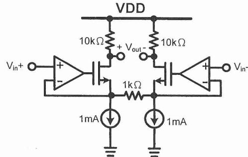
2. 分析以下電路，假設圖中運算放大器(operational amplifier)電壓增益 A 為 10 (V/V)，其餘特性皆為理想。令  $R = 1k\Omega$ ，求輸出電壓  $V_{out}$  (V)。
