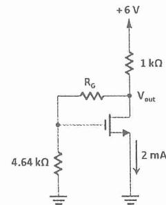
9. 下圖電路中所有電晶體臨界電壓  $V_t$  均為 0.5 V 且均操作於飽和區， $k_1'(W/L)_1 = 2$   $k_2'(W/L)_2 = 2$   $k_3'(W/L)_3 = 2$ ， $Q_2$  與  $Q_3$  之輸出電阻( $r_o$ )均為  $0.8 \text{ k}\Omega$ ，其中  $k' \equiv \mu_n C_{ox}$ 。假設  $Q_2$  之閘極(gate)電壓偏壓在 1 V，請計算  $I_{REF}$  使得小訊號電壓增益  $V_{out}/V_{in}$  為 0.8。
